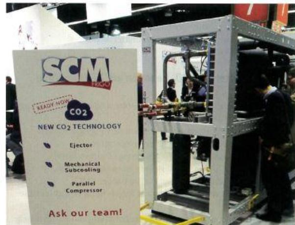
Die drei Möglichkeiten der Effizienzsteigerung von transkritischen CO<sub>2</sub>-Kälteanlagen: Ejektor (siehe Kasten), mechanical Subcooling – eine kleine zusätzliche Kälteanlage zur Vergrößerung der Unterkühlung – und parallele Verdichtung für Normal- und Tiefkühlung. Alle drei Maßnahmen lassen sich auch bei HFKW-Kälteanlagen anwenden, nur ist dort der Effizienzgewinn nicht so hoch, weshalb sich häufig die Mehrinvestitionen nicht lohnen. (alle Abb. M. Kauffeld)
