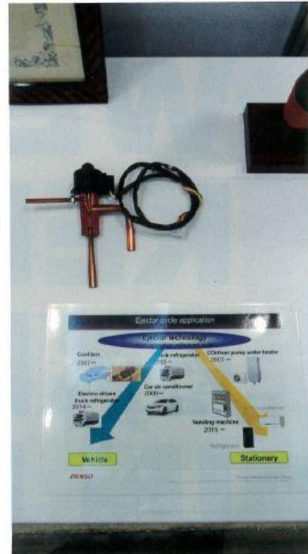
Ejektor für CO<sub>2</sub> mit verstellbarer Düse. Er wird zum Beispiel von Carel/Carrier, Compact oder Denso erprobt.
