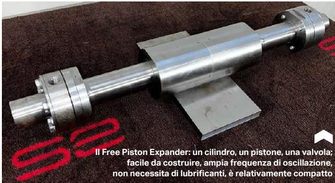
Il Free Piston Expander: un cilindro, un pistone, una valvola; facile da costruire, ampia frequenza di oscillazione, non necessita di lubrificanti, è relativamente compatto
