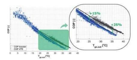
Esta figura muestra los incrementos de COP obtenidos ya desde temperaturas ambiente por debajo de los 20°C que se incrementan significativamente a temperaturas por encima de 30°C
