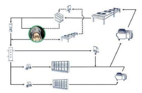
ETE incluye un compresor dedicado que devuelve el vapor de baja presión de salida del sub enfriador a la entrada del gas-cooler mientras que, por su lado, XTE aprovecha la energía recuperada durante la expansión transcritica para comprimir el vapor de baja presión de salida del sub enfriador en un gas-cooler dedicado.
